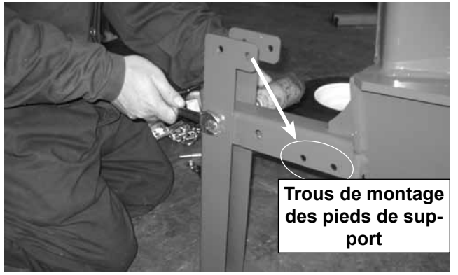
Fig. 6 PIED ET PROFILÉ DE LA FLÈCHE D'ATTELAGE
