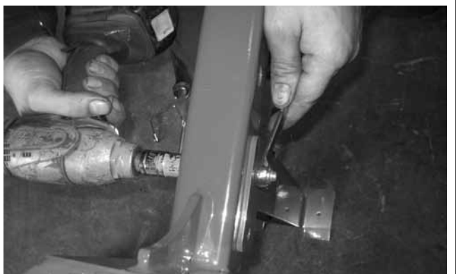
Installez le boulon du pied de support.
