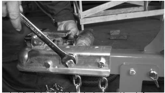
Installez le bras d'attelage, les boulons et les chaînes.
