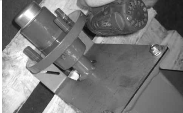
Enlevez les pièces de fixation hors des supports installés pour le transport.
